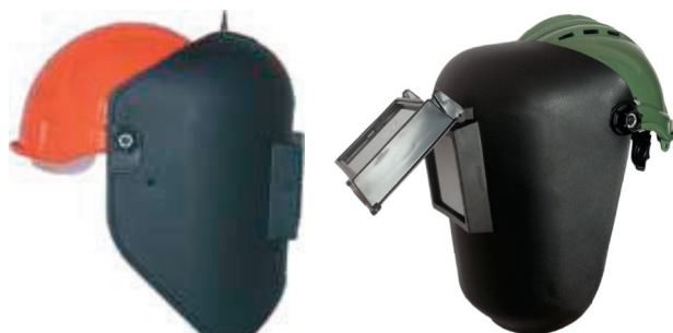
1 przyłbica spawalnicza plastikowa z kaskiem i z filtrem 90x110 i, lub uchylną ramką filtra per helmet zespół zawiasowy pozwala na odchylenie przyłbicy w górę i w dół oraz stabilne zatrzymanie jej w wybranej pozycji
